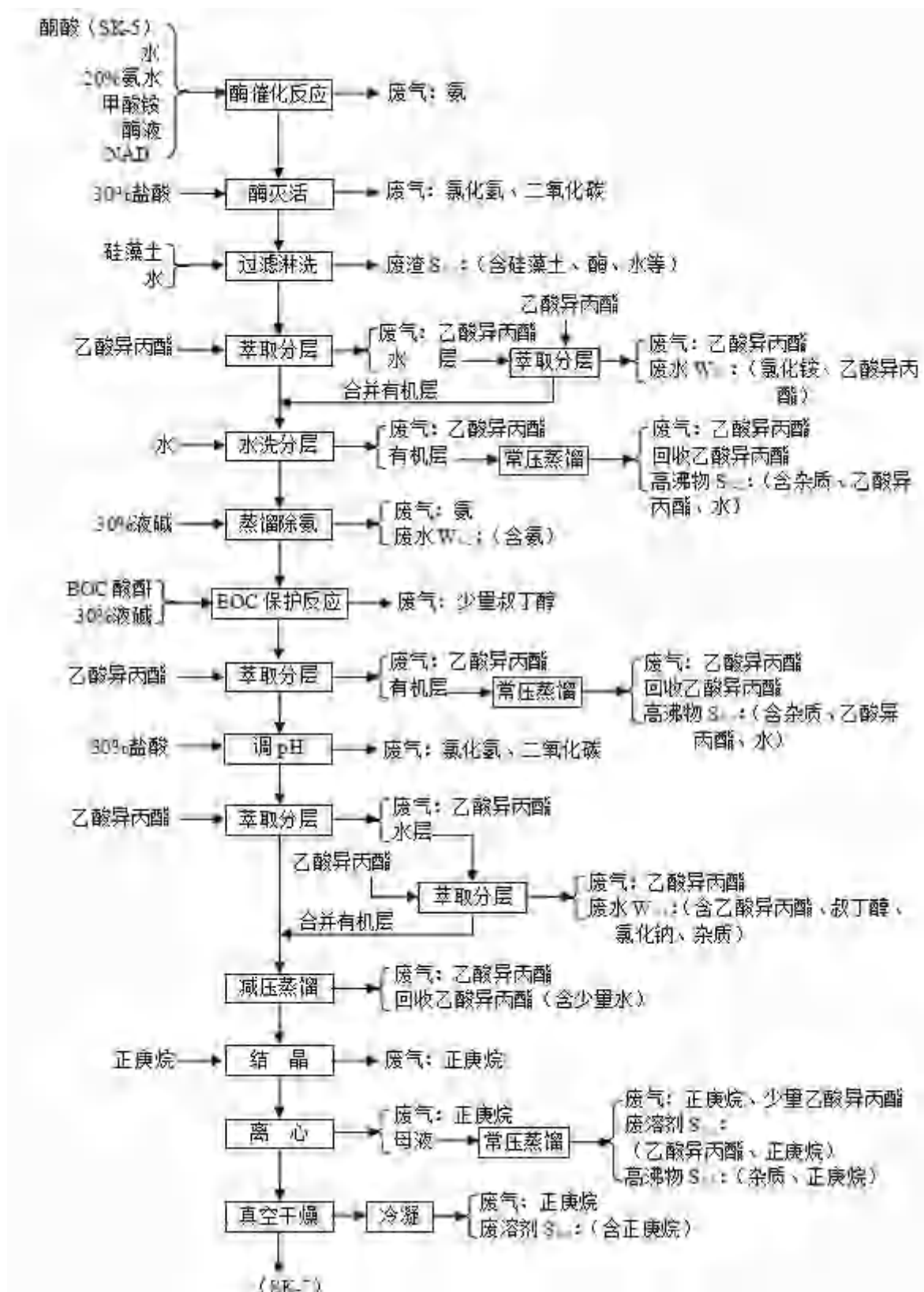
图 3-7 年产 3 吨沙克列汀中间体 SK-7 项目生产工艺流程图（单位：kg/批）
