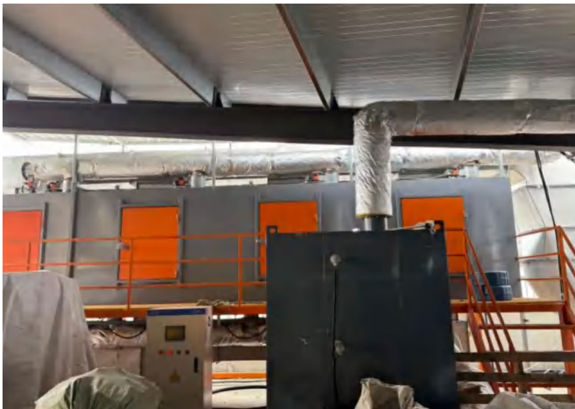
水喷淋塔+干式过滤+活性炭吸附/脱附+催化燃烧处理设施
