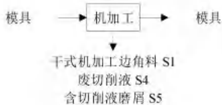
图 2.6-2 工装生产工艺流程及产污环节示意图
