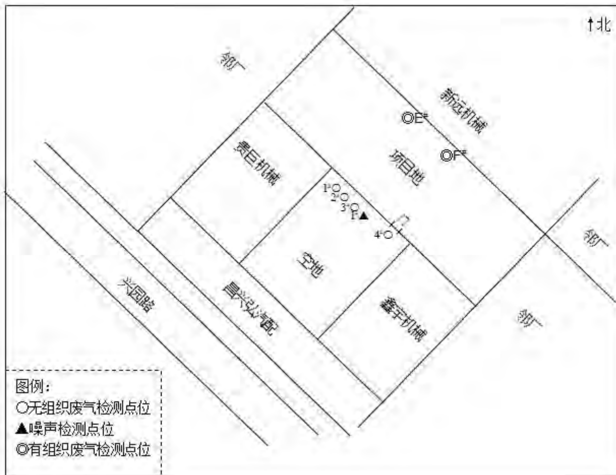
图 7.2-1 噪声、废气监测点位置分布图
