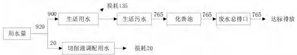
图 2.5-1 本项目环评水平衡图（单位：t/a）
